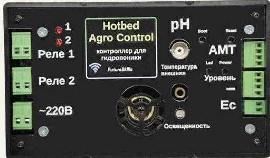
Контроллер обладает набором датчиков, измеряющих влажность воздуха, температуру воздуха, температуру раствора, уровень жидкости, **EC**, **Lux** (уровень освещения) и **PH**.
