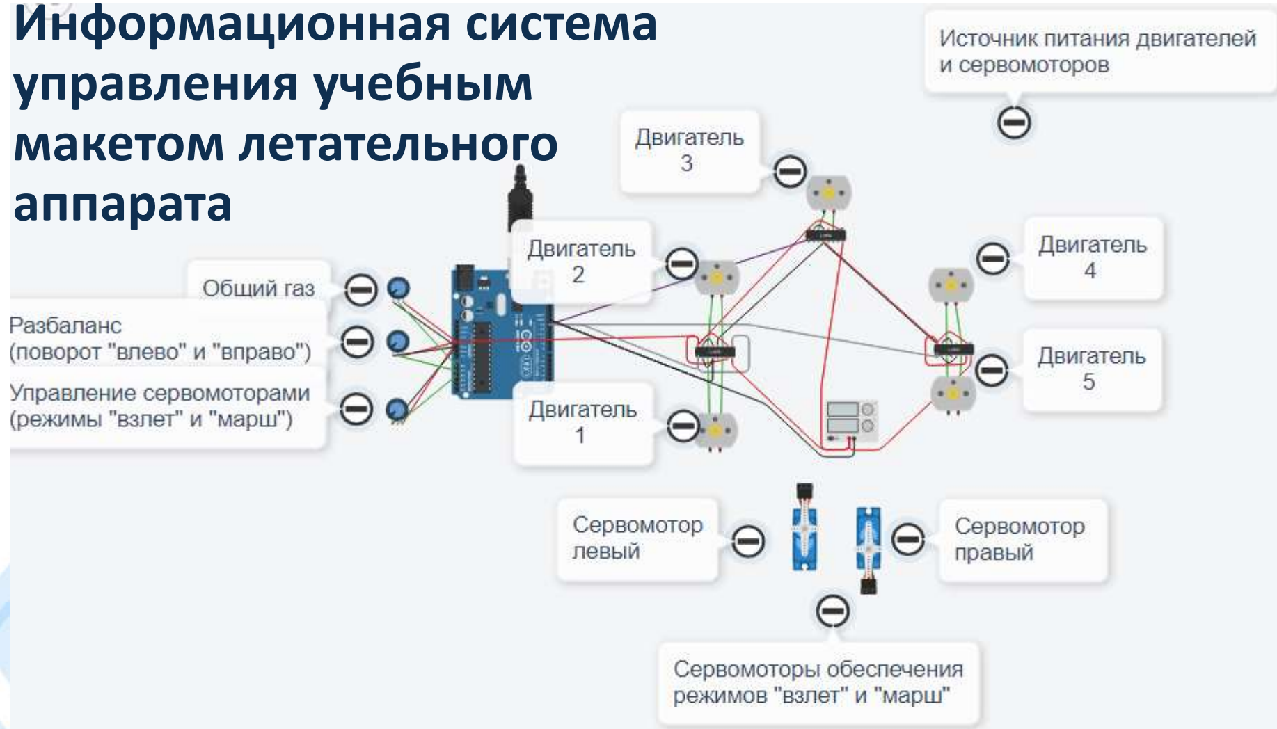
Рисунок 3 – Моделирование системы в среде моделирования Tinkercad
